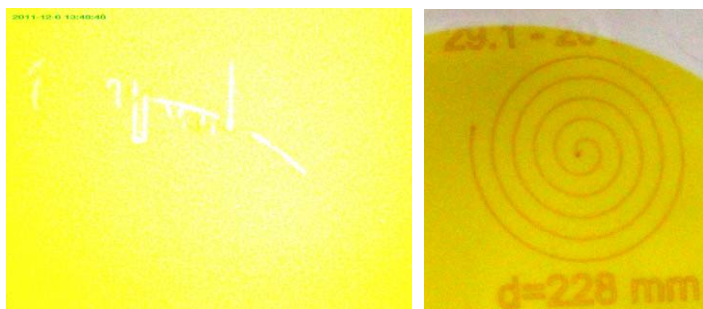
Rys. 6. Fotografie wyników laserowej aktywacji próbki pokrytej żółtym pigmentem X1055. Z lewej strony nieudana próba aktywacji za pomocą lasera iterbowego ciągłego działania na długości fali 1090 nm, z prawej strony skuteczna aktywacja za pomocą lasera pikosekundowego na długości 532 nm
