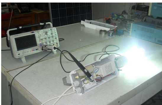
Rys. 11. Widok stanowiska do badania statecznika dławikowego (klasycznego)
