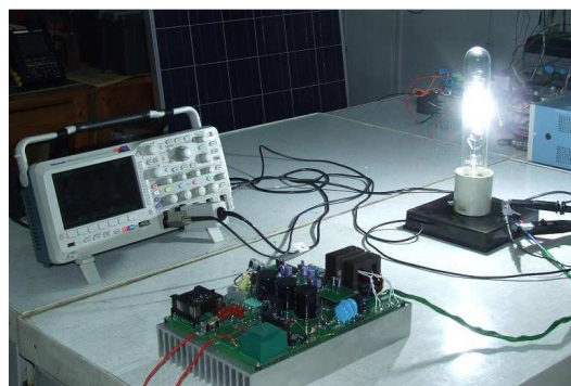
Rys. 12. Widok stanowiska do badania statecznika elektronicznego
