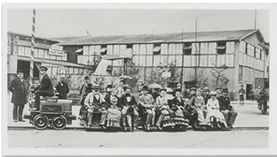
Rys. 1. Pierwsza na świecie kolej elektryczna, konstrukcji W. von Siemens na Berlińskiej Wystawie Przemysłowej w 1879 roku [6]
