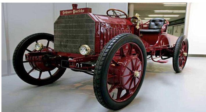
Rys. 2. W 1898 roku Ferdynand Porsche w austriackiej fabryce Lohner opracował konstrukcję napędu elektrycznego o mocy 12 KM, nadający się do wbudowania w piastę koła pojazdu [7, 8]
