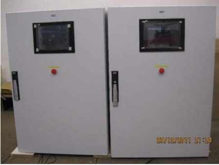
Rys. 6. Terminale szybkiego ładowania w trakcie testów zbudowane w Instytucie Elektrotechniki
