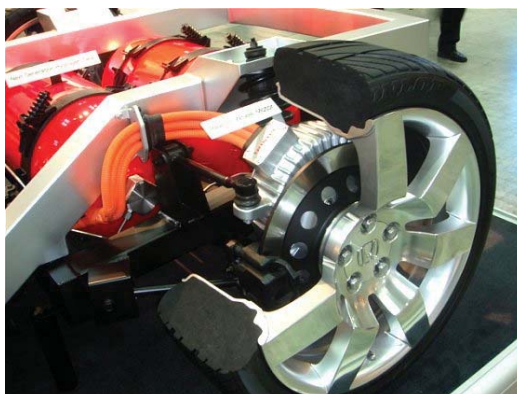
Rys. 4. Układ napędowy bezpośredni skonstruowany przez firmę Honda (źródło: [ 7 ] )
