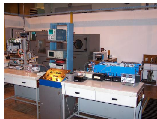
Rys. 4. Stanowisko do badań podzespołów o napięciu zasilania 750V DC.
