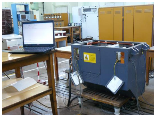
Rys.2. Stanowisko do badań przetwornic statycznych 3000V DC.
