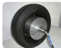
Silnik typu EMZm 60-12 zamontowany w standardowym kole pojazdu (widok od wewnątrz)
