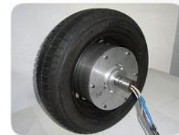
Silnik typu EMZm 60-12 zamontowany w standardowym kole pojazdu (widok od wewnątrz)
